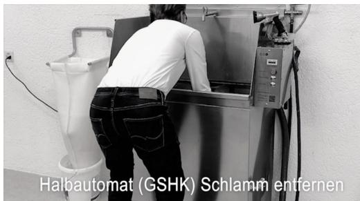
Halbautomat (GSHK) Schlamm entfernen
