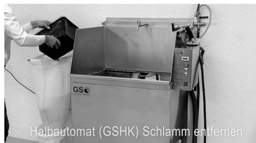
Halbautomat (GSHK) Schlamm entfernen
